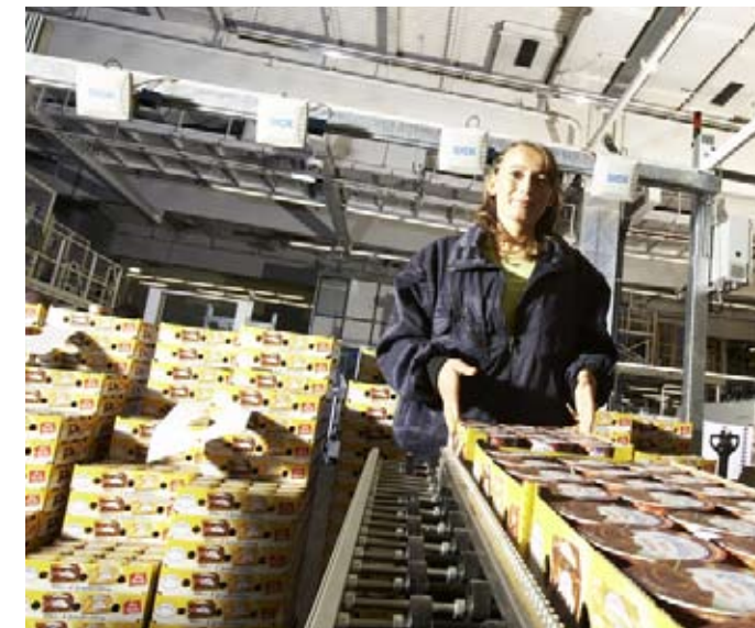
Chargenverfolgung im Lager mithilfe von RFID-Pads, die sich auf den Paletten befinden.
