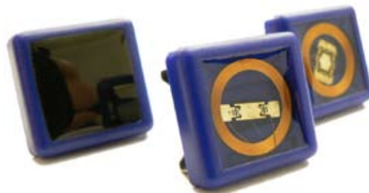
Legic- und Mifare-Smartclips mit 13,56 MHz-Technik
