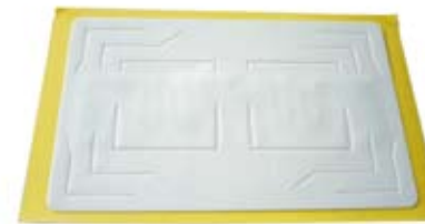
UHF-Label für Windschutzscheiben ermöglichen den Zutritt zu Parkanlagen.
