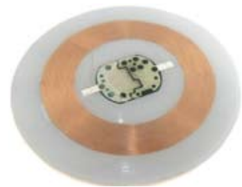
Hitag-1-Transponder mit 125 kHz auf einem adhäsiv auf Glas haftenden Tag
